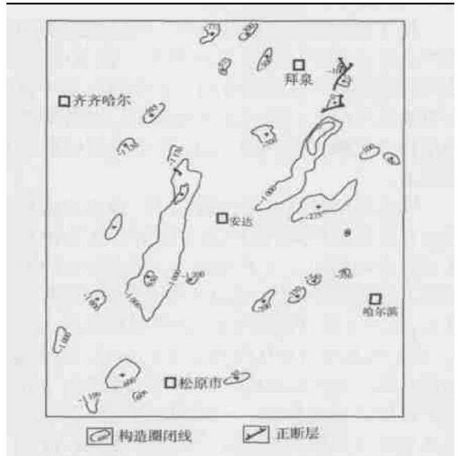
图6 松辽盆地 T_1 层构造圈闭平面分布图
